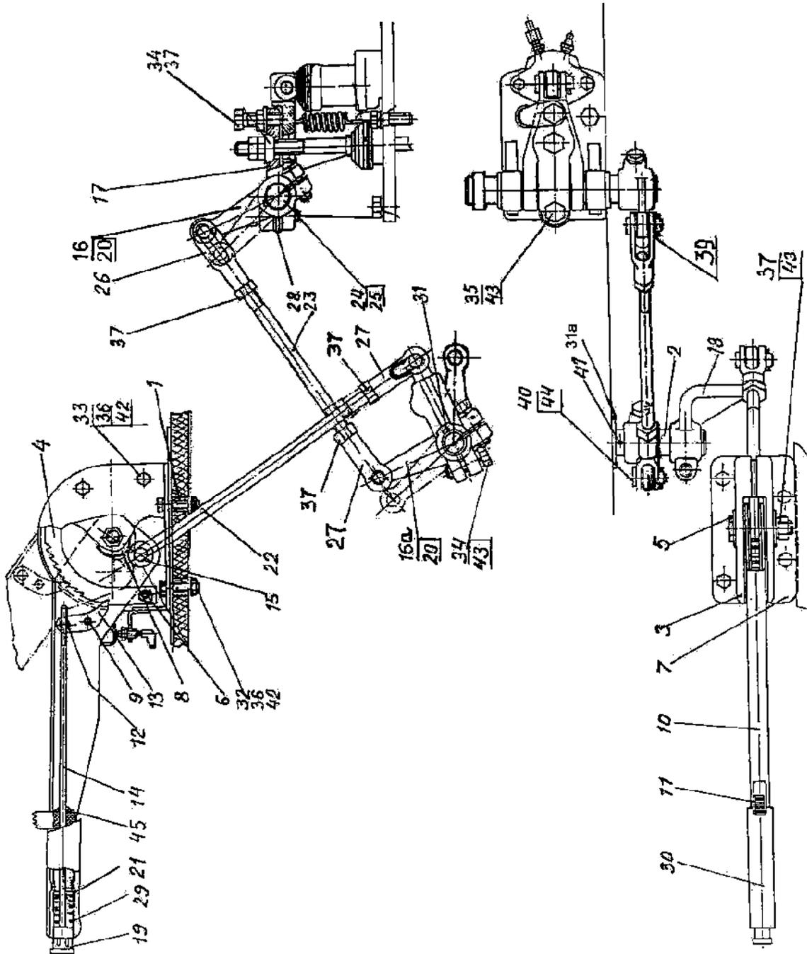
Рис. 70. Управление стояночным тормозом
