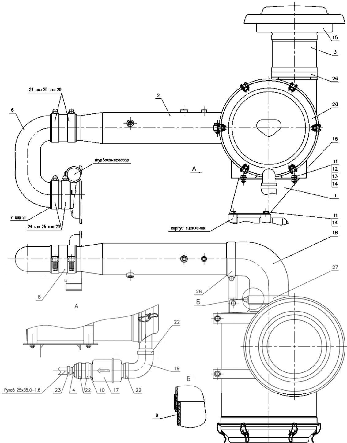
Рис. 5. Установка воздухоочистителя (для тракторов 2522ДВ/2522.1/3022ДВ/3022.1)
