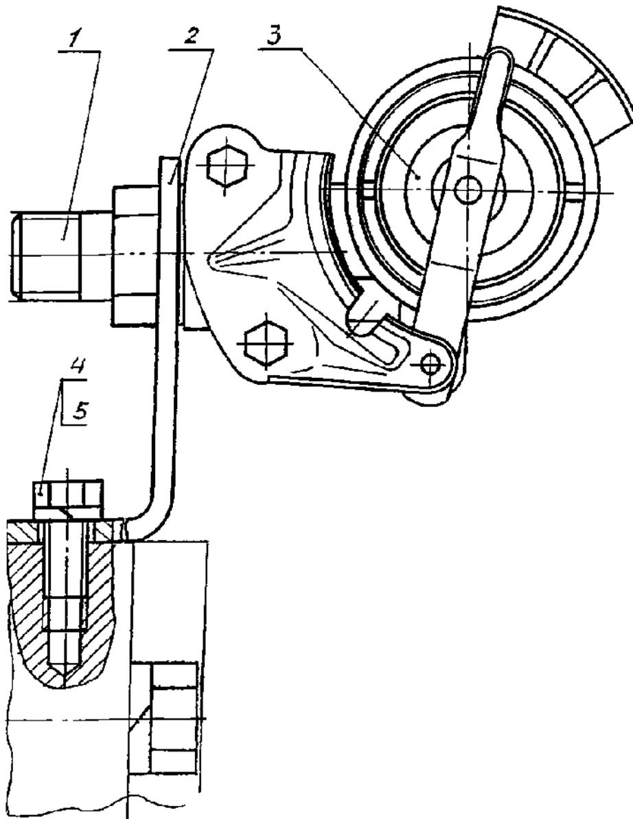
Рис. 79. Установка соединительной головки (однопроводный пневмопривод тормозов прицепа)
