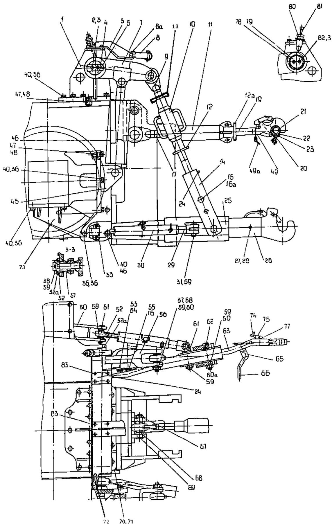
Рис. 107. Механизм задней навески
