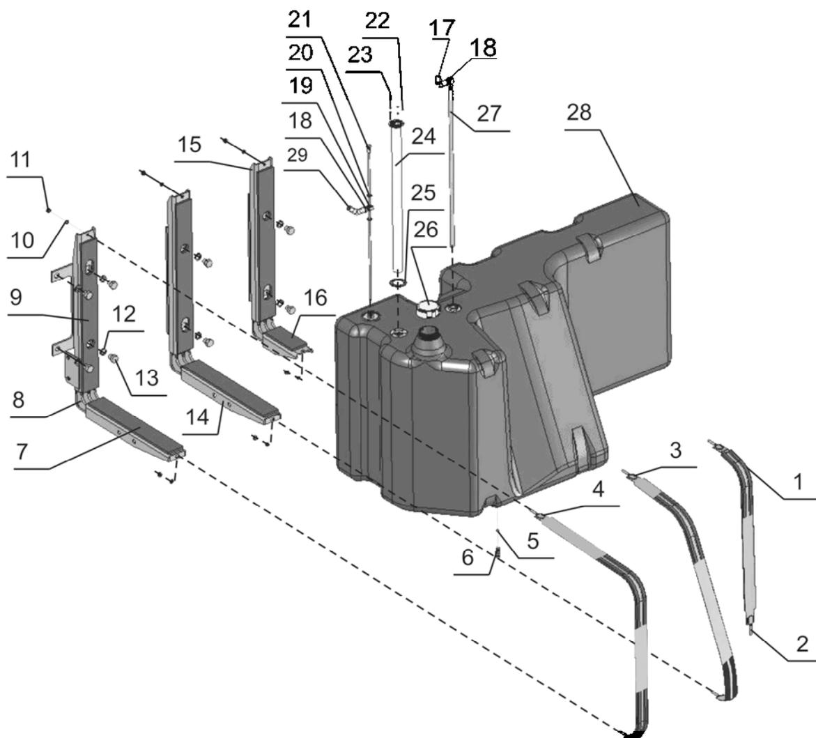
Рис. 3. Бак топливный
