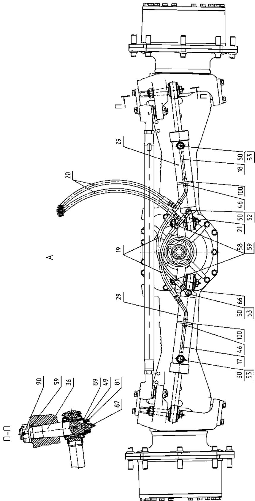
Рис. 61.3. Управление рулевое (для тракторов 2822ДЦ/2822.1)
