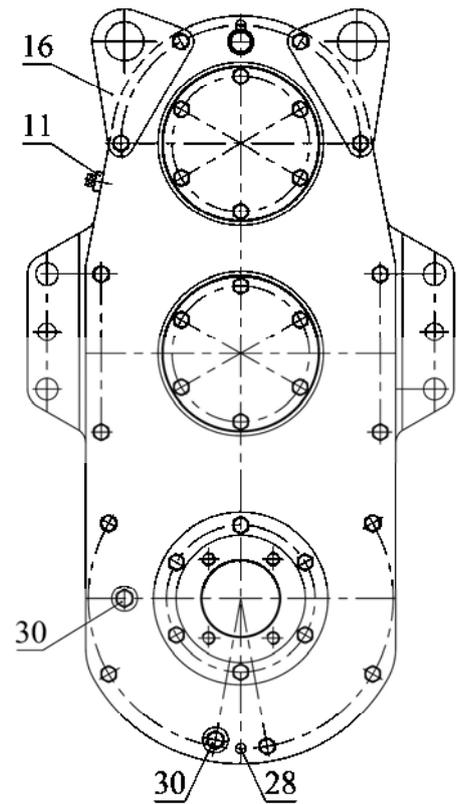
Рис. 102. Передний ВОМ. Редуктор 2822-4209010/2822ДЦ-4209010
