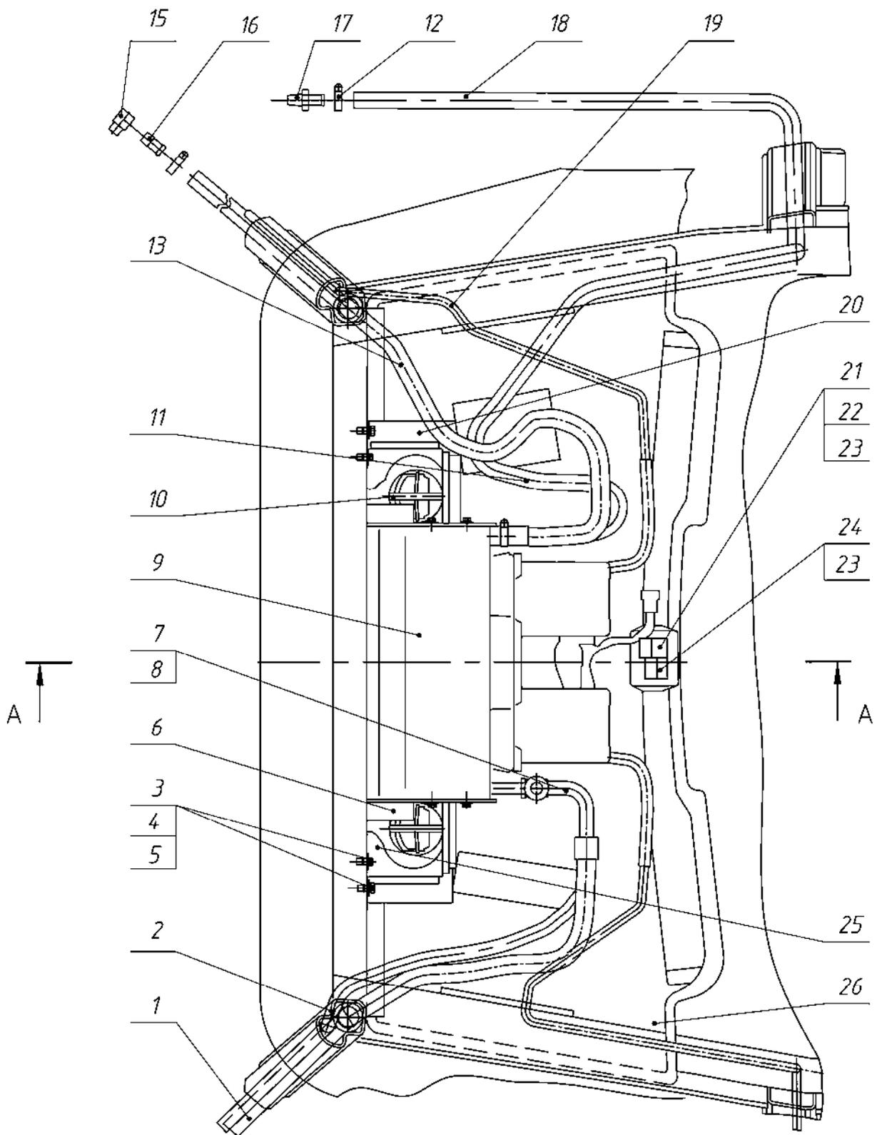
Рис. 125. Установка отопителя-охладителя
