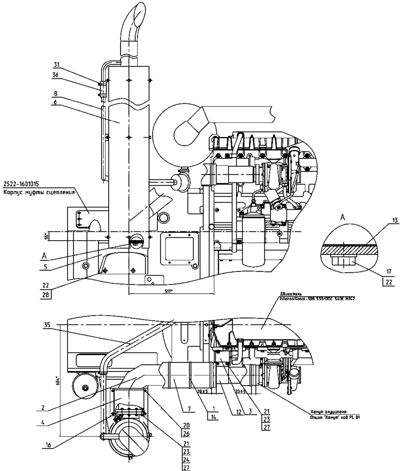
Рис. 7. Установка глушителя (для тракторов 2522ДВ/2522.1/3022ДВ/3022.1)
