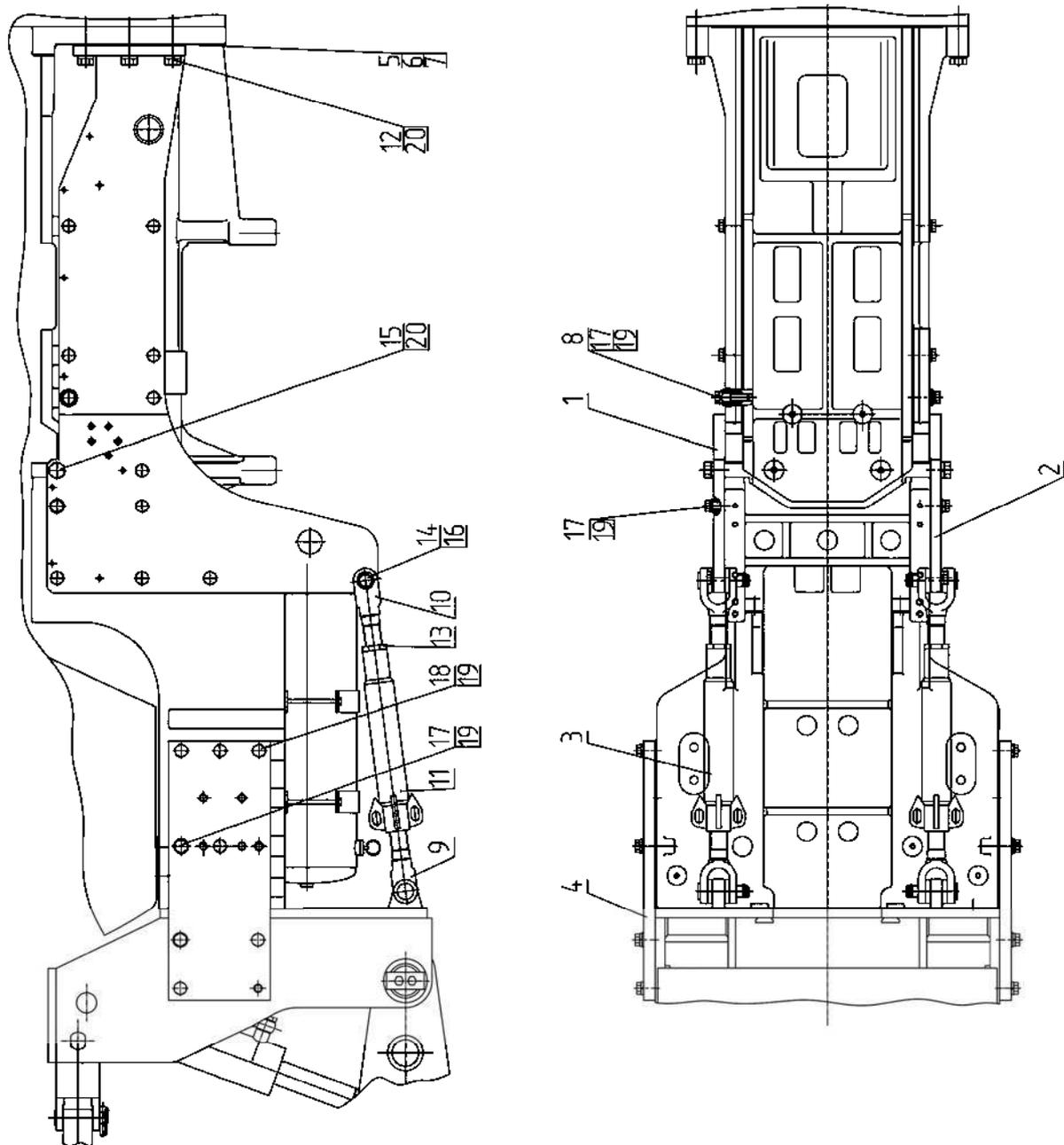
Рис. 109. Установка переднего навесного устройства
