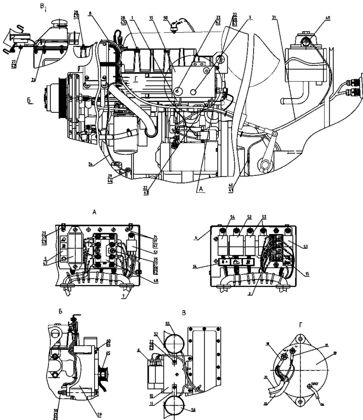
Рис. 92. Электрооборудование двигателя (2522ДВ/2522.1/3022ДВ/3022.1)
