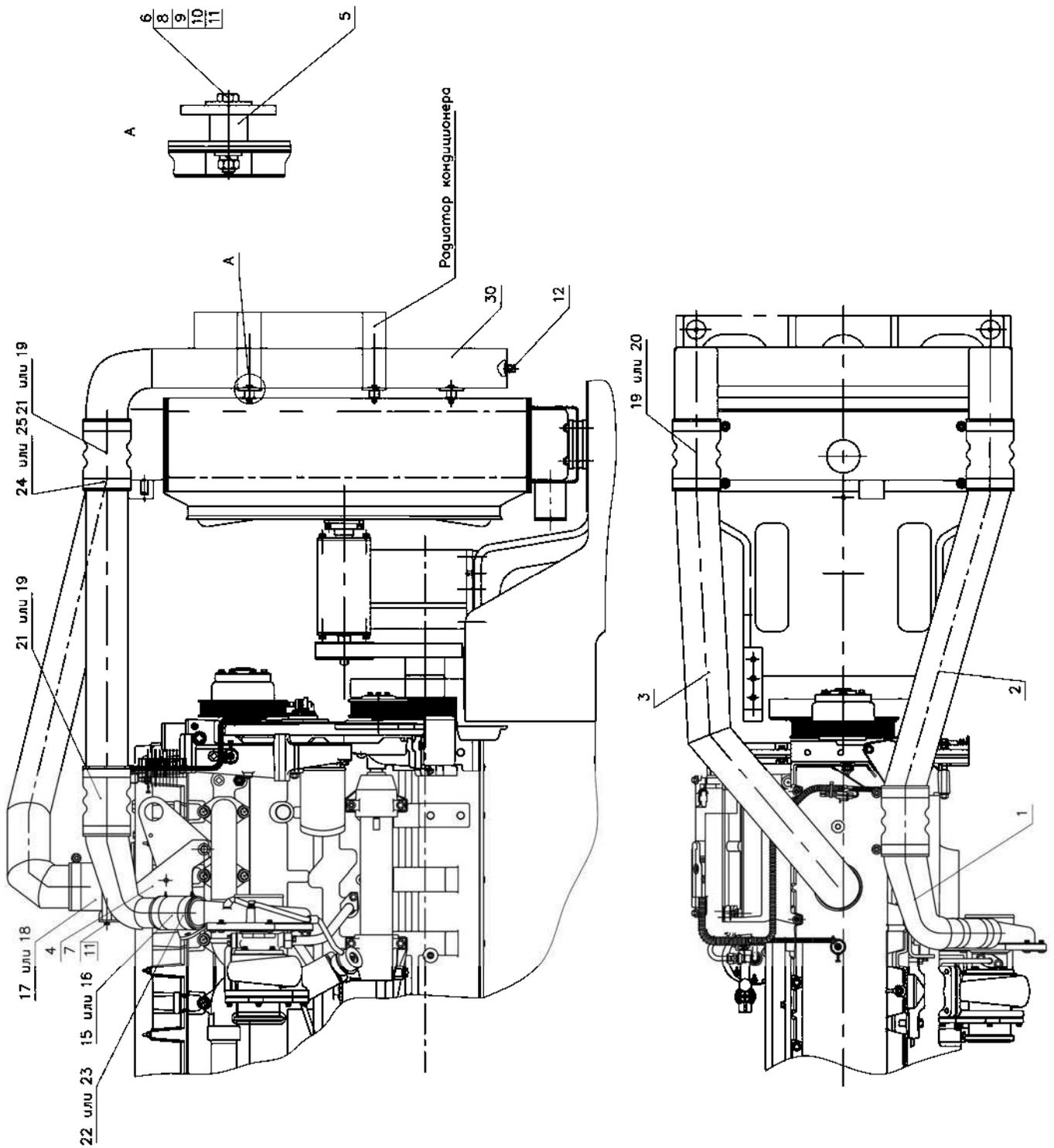
Рис. 12. Установка охладителя (для тракторов 2522ДВ/2522.1/3022ДВ/3022.1)
