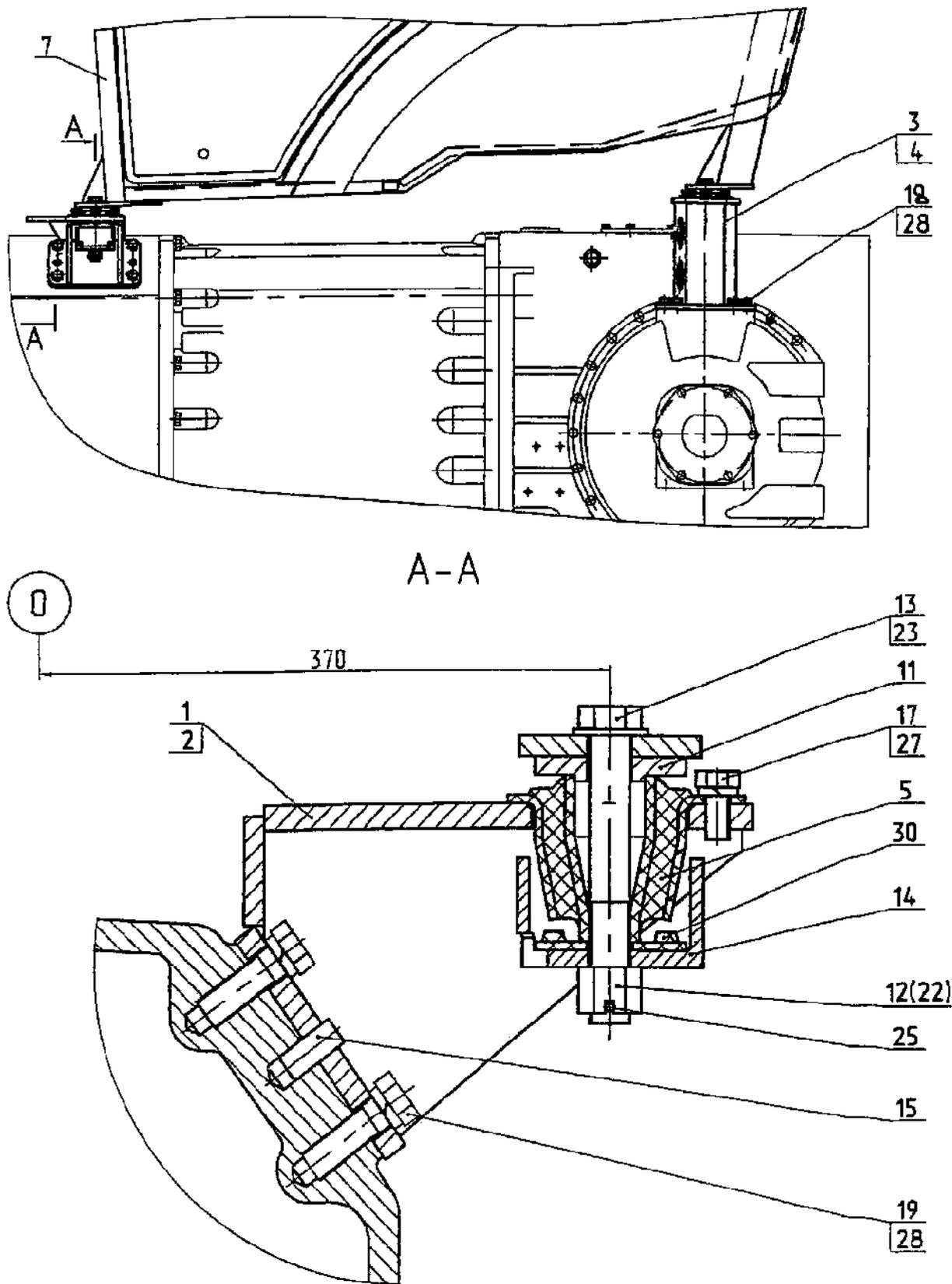
Рис. 115. Установка кабины
