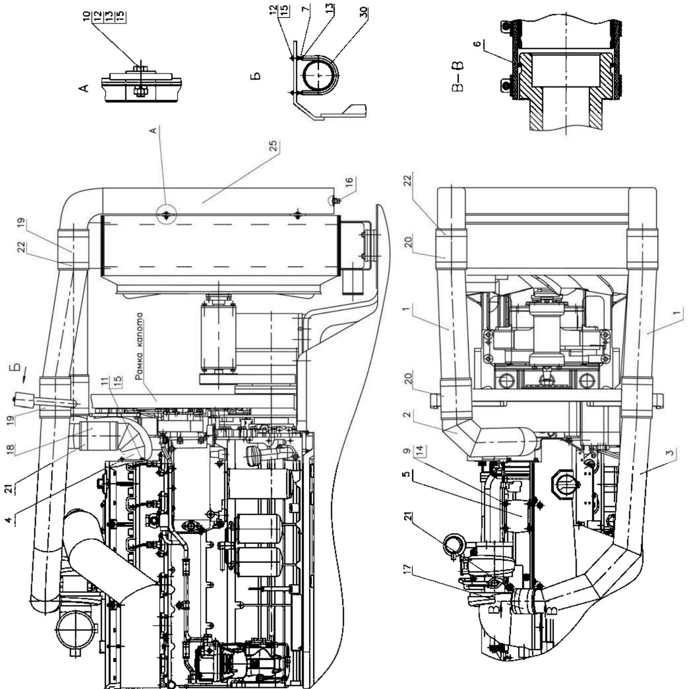
Рис. 13. Установка охладителя (для тракторов 2822ДЦ/2822.1)
