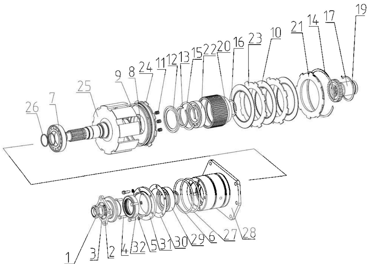
Рис. 36. Муфта привода ПВМ
