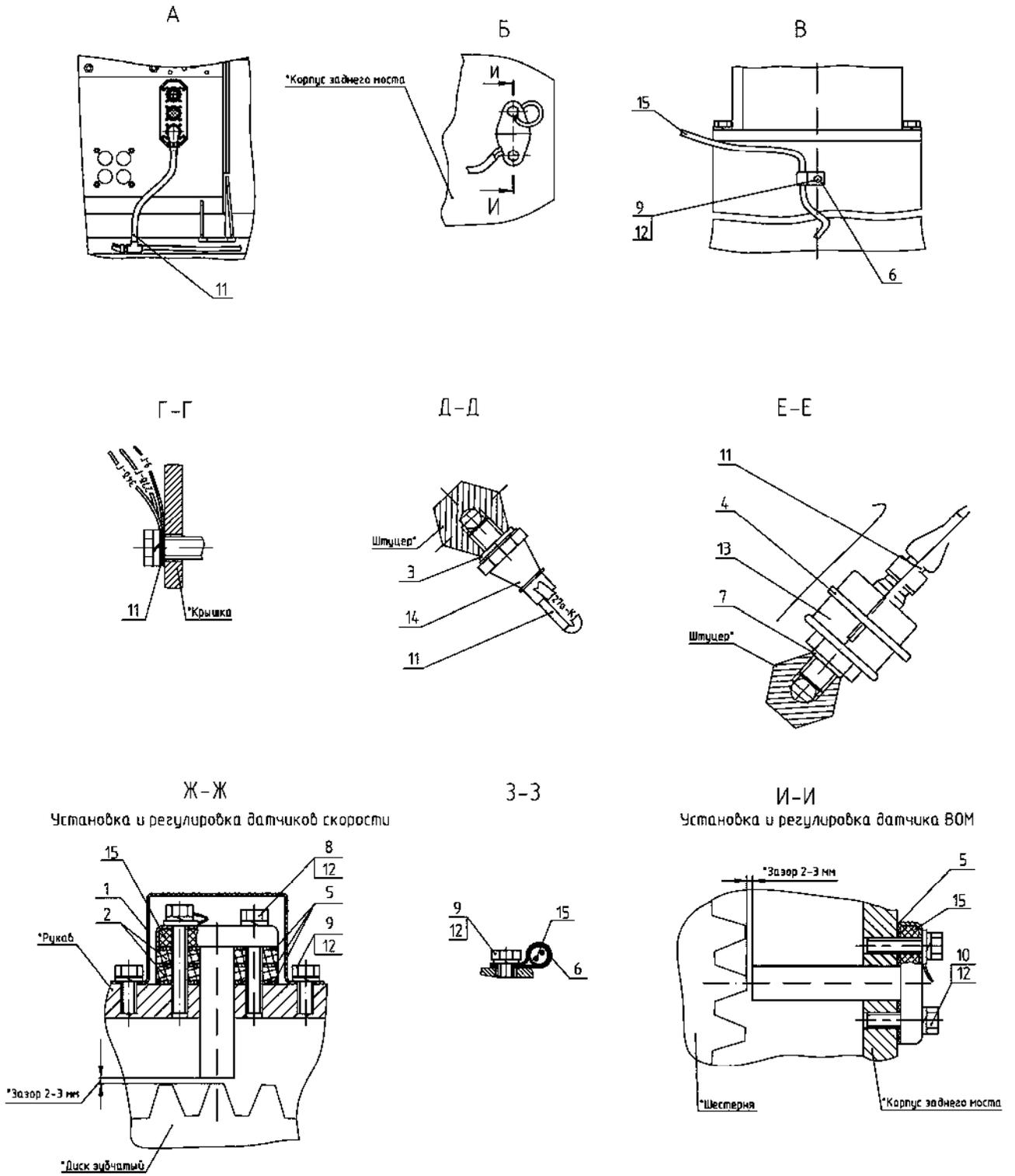
Рис. 89.2. Электрооборудование трансмиссии
