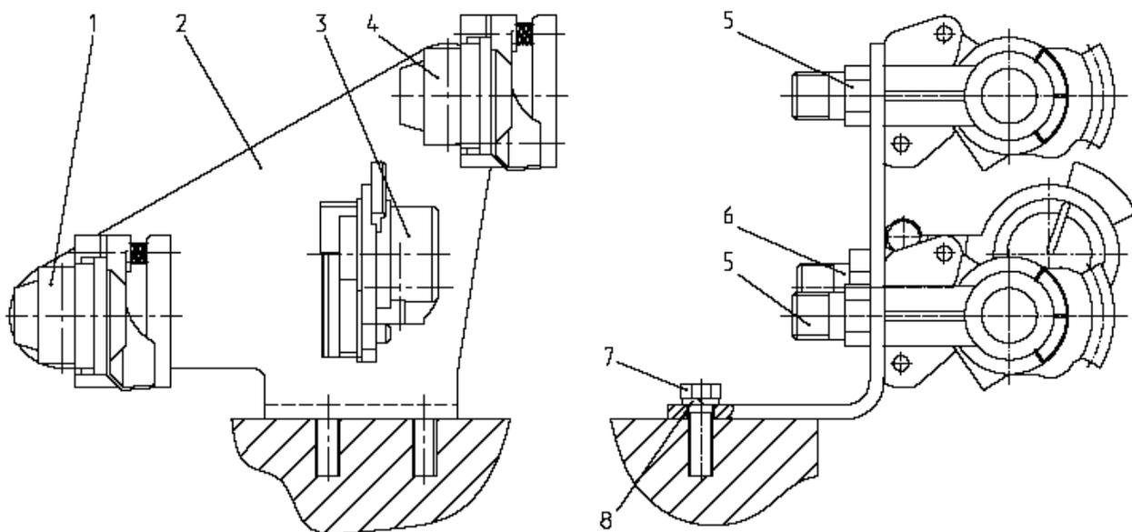
Рис. 80. Установка соединительной головки (комбинированный пневмопривод тормозов прицепа)
