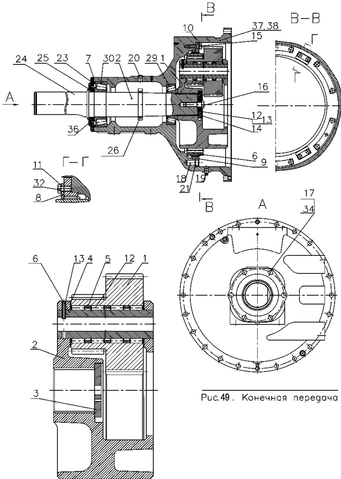
Рис. 49. Конечная передача
