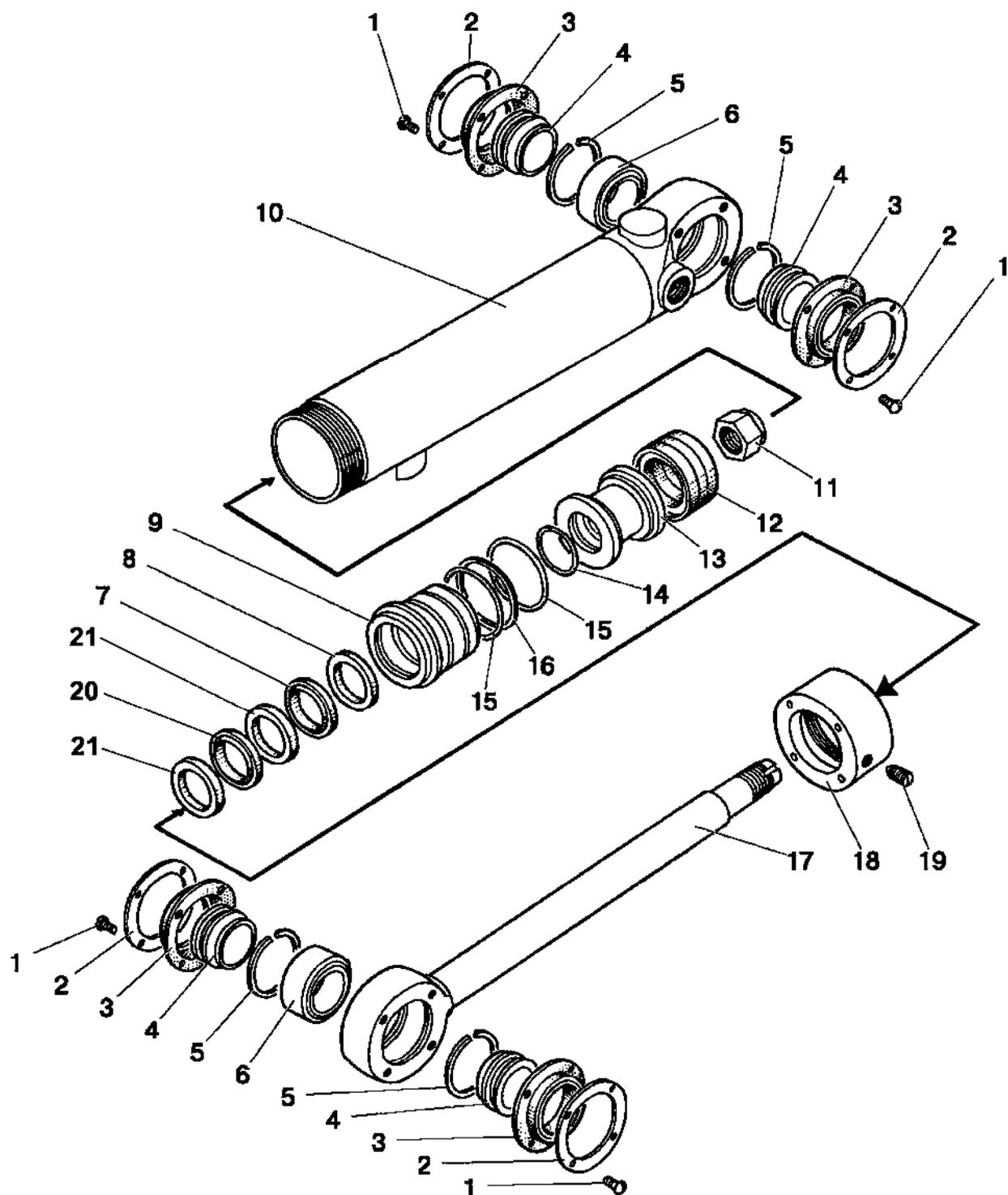
Рис. 65. Гидроцилиндр Ц63 (63x30-250)
