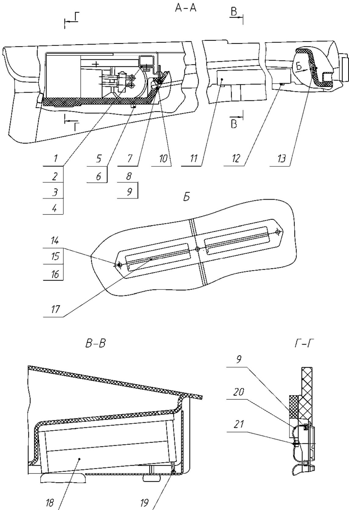
Рис. 126. Установка отопителя-охладителя
