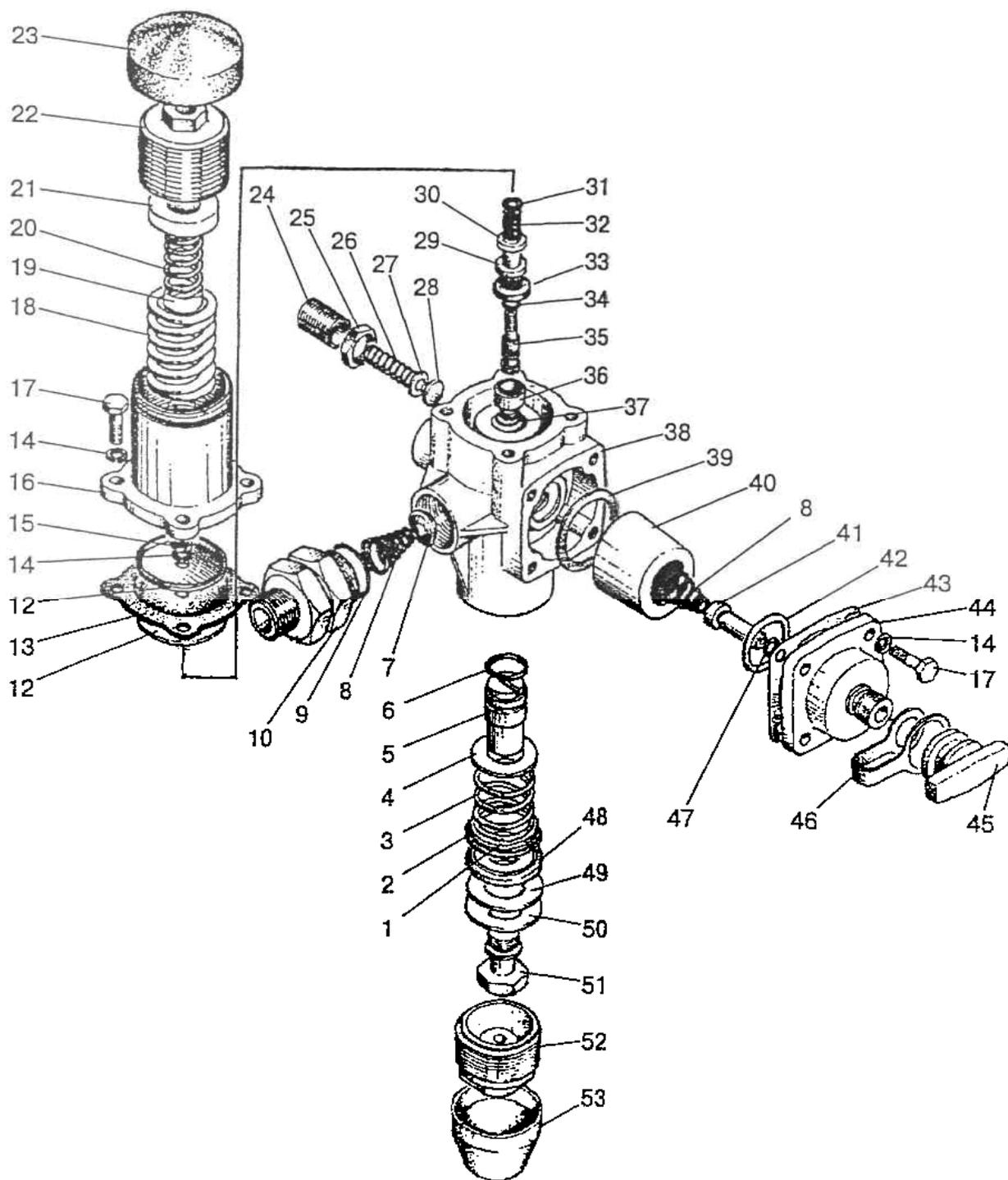
Рис. 73 Регулятор давления
