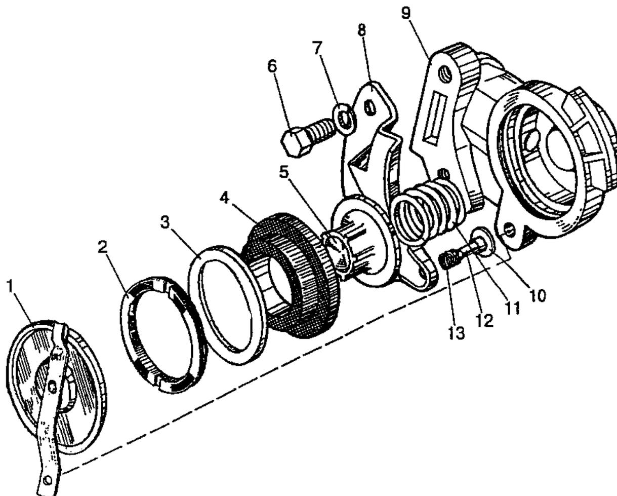
Рис. 81. Головка соединительная (однопроводная)
