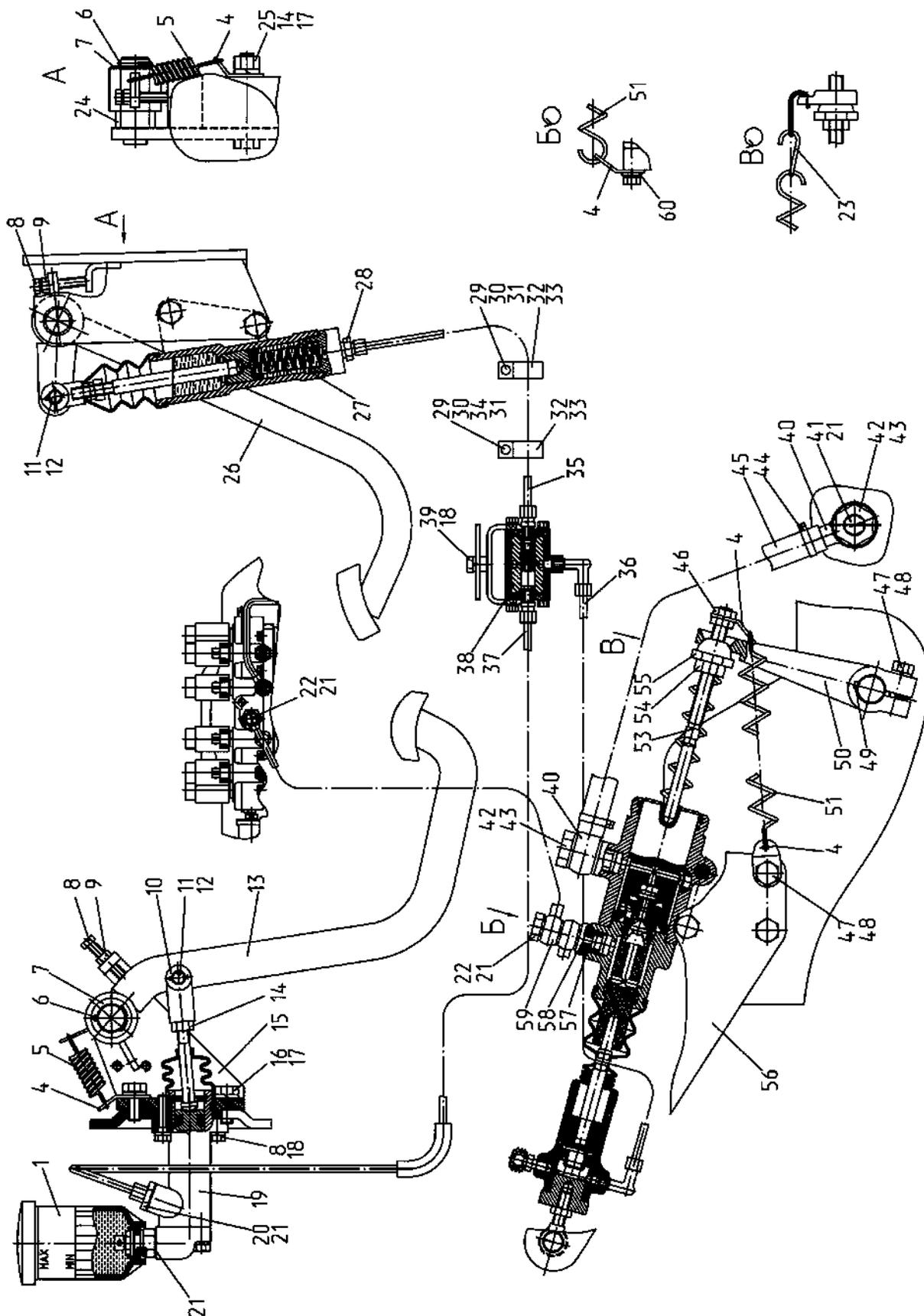
Рис. 18. Управление сцеплением
