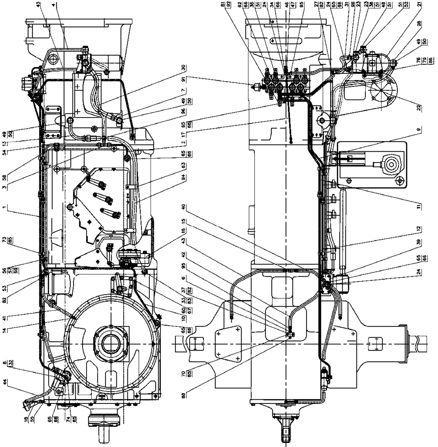
Рис. 112. Система смазки и управления трансмиссии
