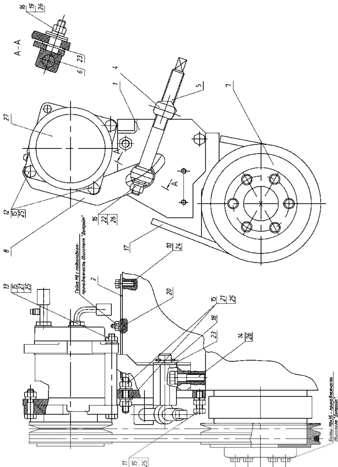
Рис. 128. Установка компрессора (для тракторов 2522ДВ/2522.1/3022ДВ/3022.1)
