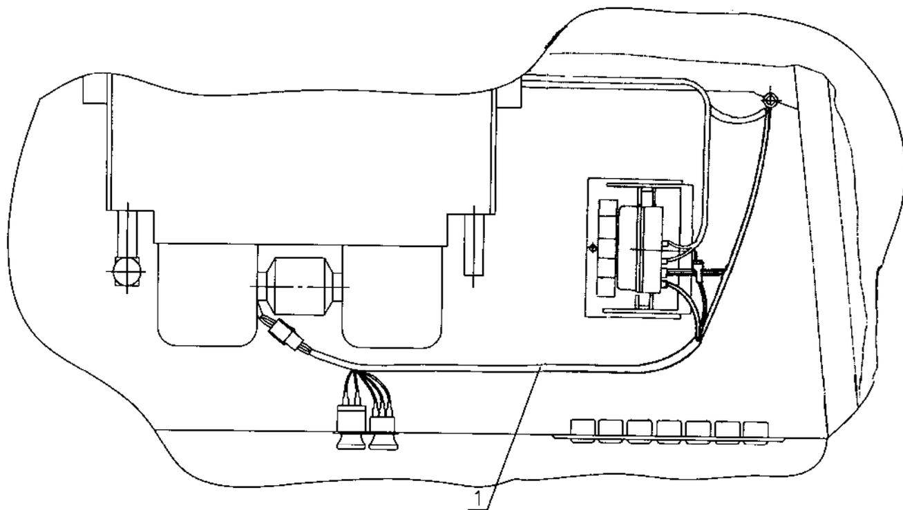
Рис. 88. Электрооборудование кондиционера
