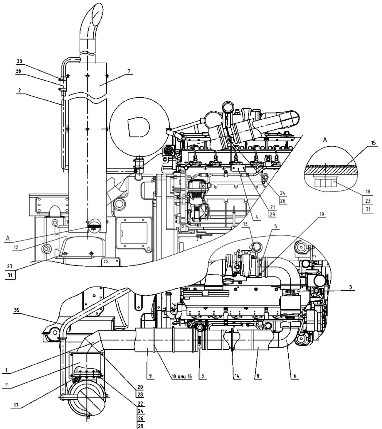
Рис. 8. Установка глушителя (для тракторов 2822ДЦ/2822.1)
