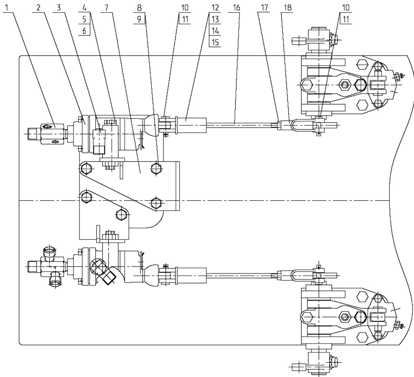
Рис. 75 Установка однопроводного крана тормозного
