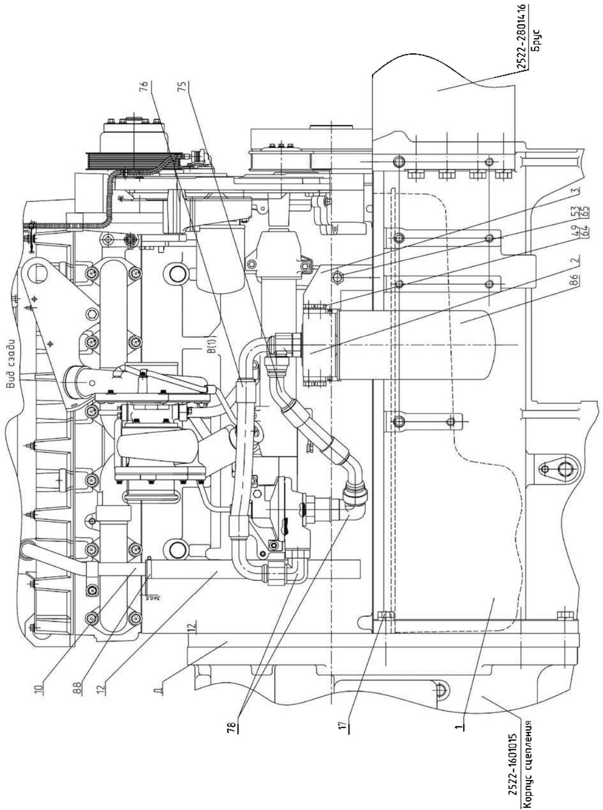
Рис.1.2. Установка дизеля (для тракторов 2522ДВ/3022ДВ/2522.1/3022.1)
