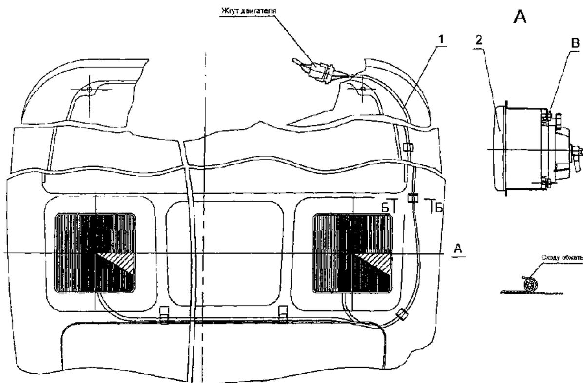
Рис. 83. Установка фар дорожных
