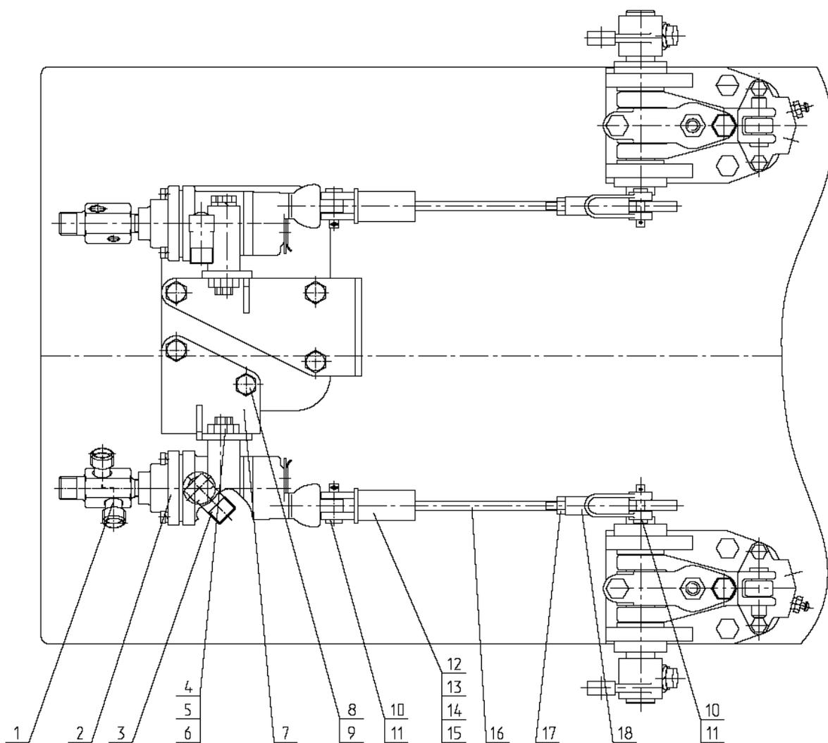
Рис. 76 Установка двухпроводного крана тормозного
