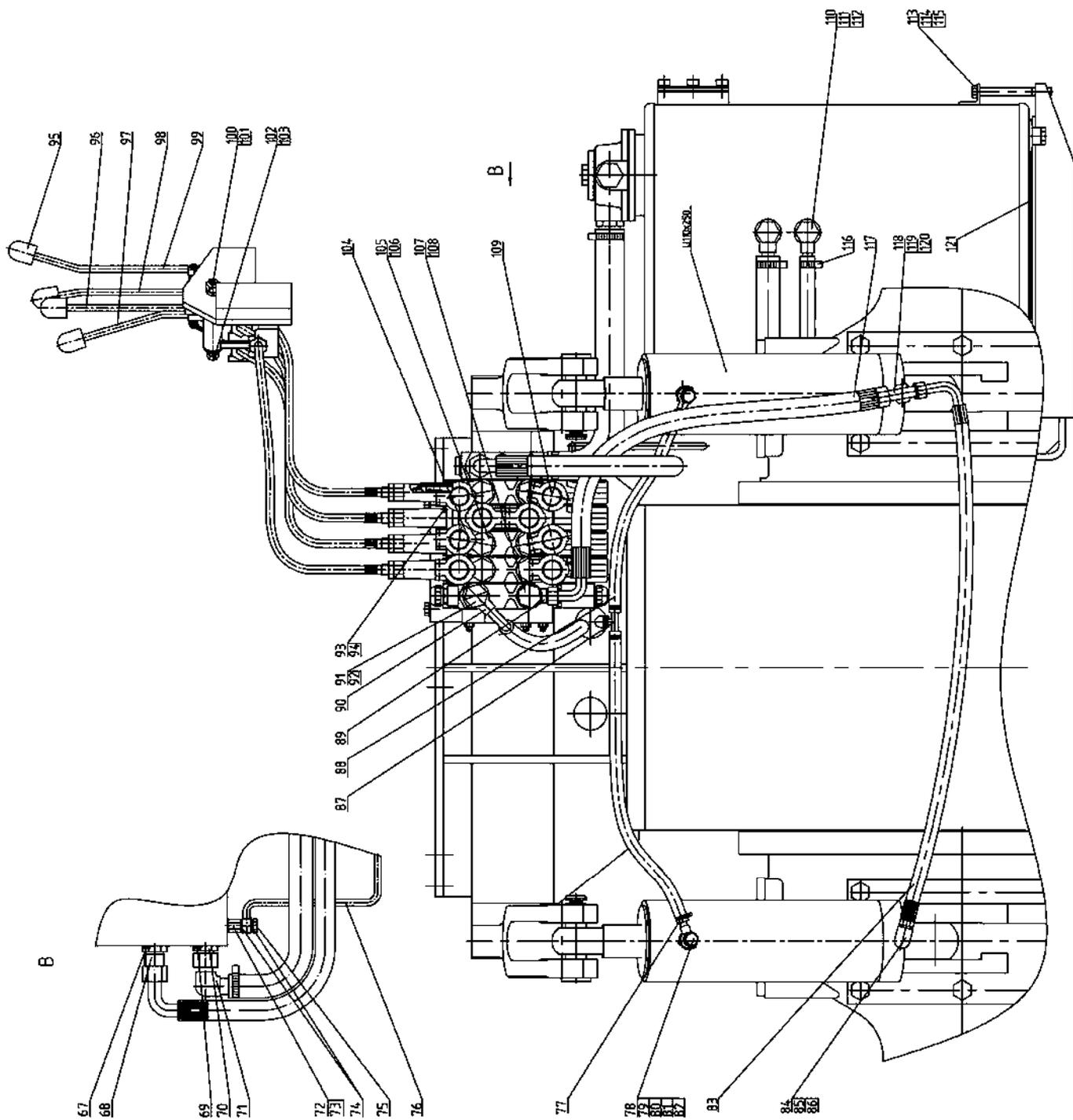
Рис. 110.2. Гидроагрегаты и арматура (для тракторов 2522ДВ/2822ДЦ/3022ДВ)
