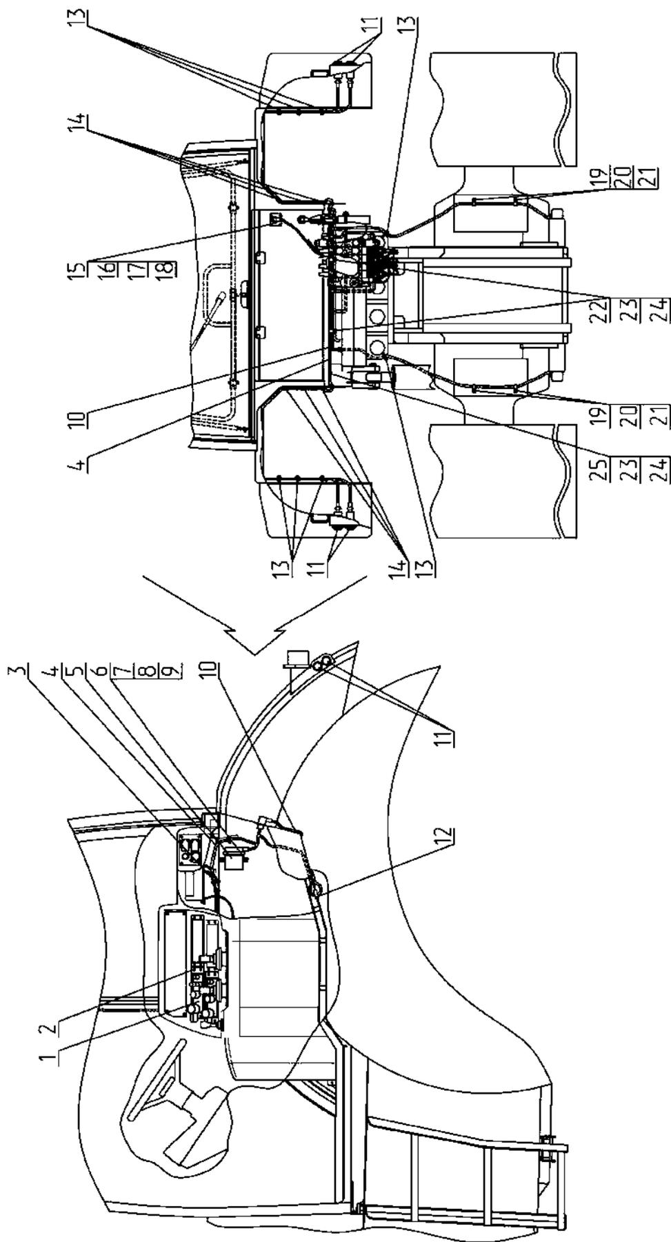
Рис.141. Управление задним навесным устройством (2522.1/3022.1/2822.1)
